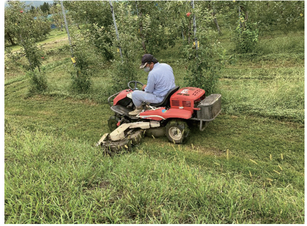
図 9. 乗用モア RMK1600 刈刃を横にスライドさせての草刈り作業
