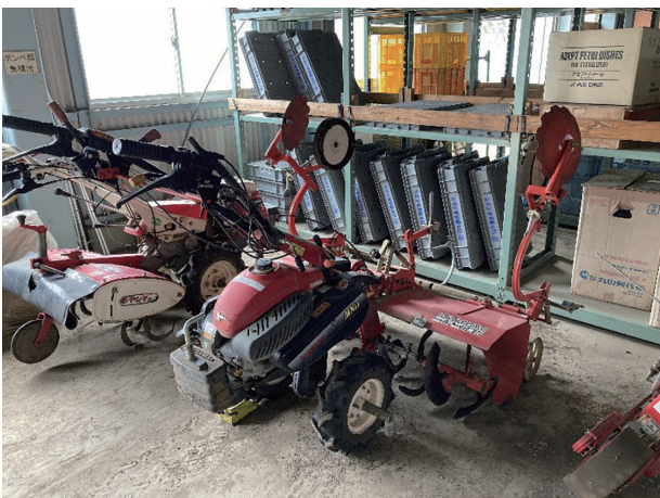
図 5. 歩行型トラクター(奥)と汎用管理機(手前)
