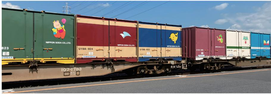
写真2. リニューアルした私有コンテナ (製品輸送用 19D 形式)
