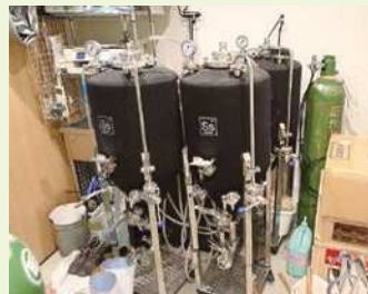
写真4. コニカルタンク
