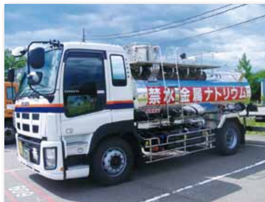
二本木工場 金属ナトリウム専用ローリー
